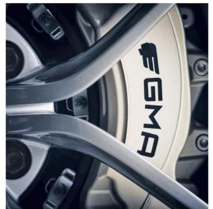
Ogni dettaglio dello stile della T.33 è dettato dalla ricerca della funzionalità, prestazionale e aerodinamica; lo stile ricorda quello di alcune berline degli anni 60. Per i freni, la scelta è caduta sui dischi di Ccm (Carbon ceramic material) della Brembo, con pinze di alluminio con sei pistoncini davanti e quattro dietro
