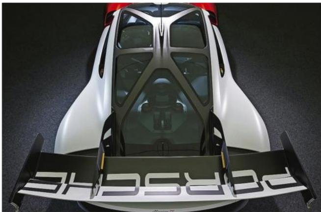
La configurazione aerodinamica della Mission R prevede la presenza di sistemi di variazione della resistenza all'avanzamento nella parte anteriore (lamelle richiudibili nelle prese d'aria) e nell'ala posteriore, il cui angolo d'incidenza è variabile. Anche i cerchi di lega leggera sono ottimizzati per orientare i flussi
