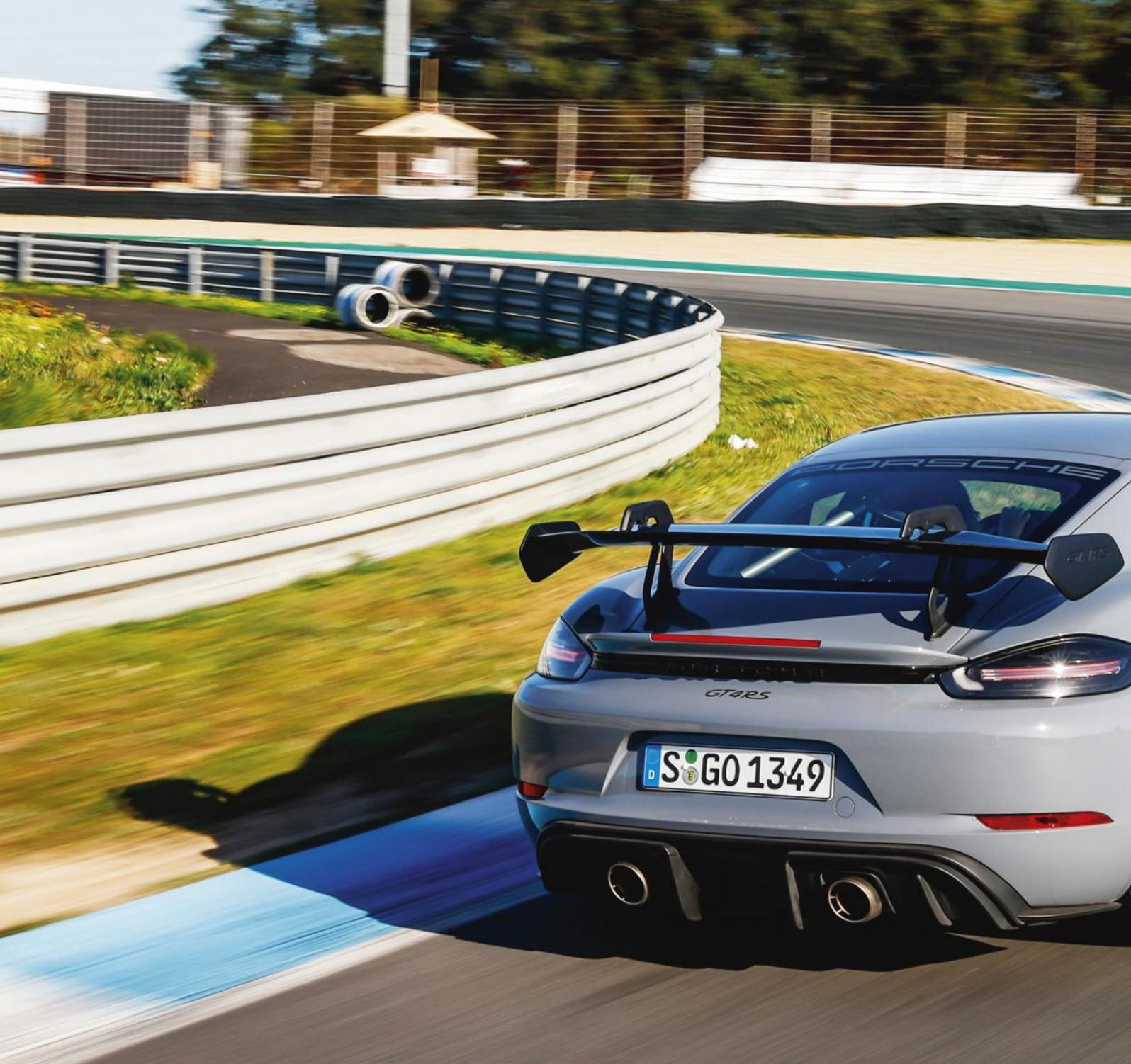
L'alleggerimento di 35 kg rispetto alla 718 Cayman GT4 è stato ottenuto adottando molti particolari di Cfrp, carbonio rinforzato con fibre polimeriche. I cerchi forgiati da 20 pollici possono essere di alluminio o, a richiesta con il pacchetto Weissach, di magnesio. L'assetto è abbassato di 30 millimetri e prevede molle e barre antirollio più rigide
