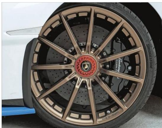
Il body kit della Huracán STO è quello della Super Trofeo utilizzata nel campionato monomarca, con qualche adattamento necessario all'omologazione per l'uso stradale: nella zona posteriore si notano le fiancate svasate, per creare più carico (in totale, 420 kg a 280 km/h). I cerchi (qui sopra) sono di magnesio, mentre i pneumatici Bridgestone Potenza sono disponibili in due versioni, una più stradale, l'altra da pista
