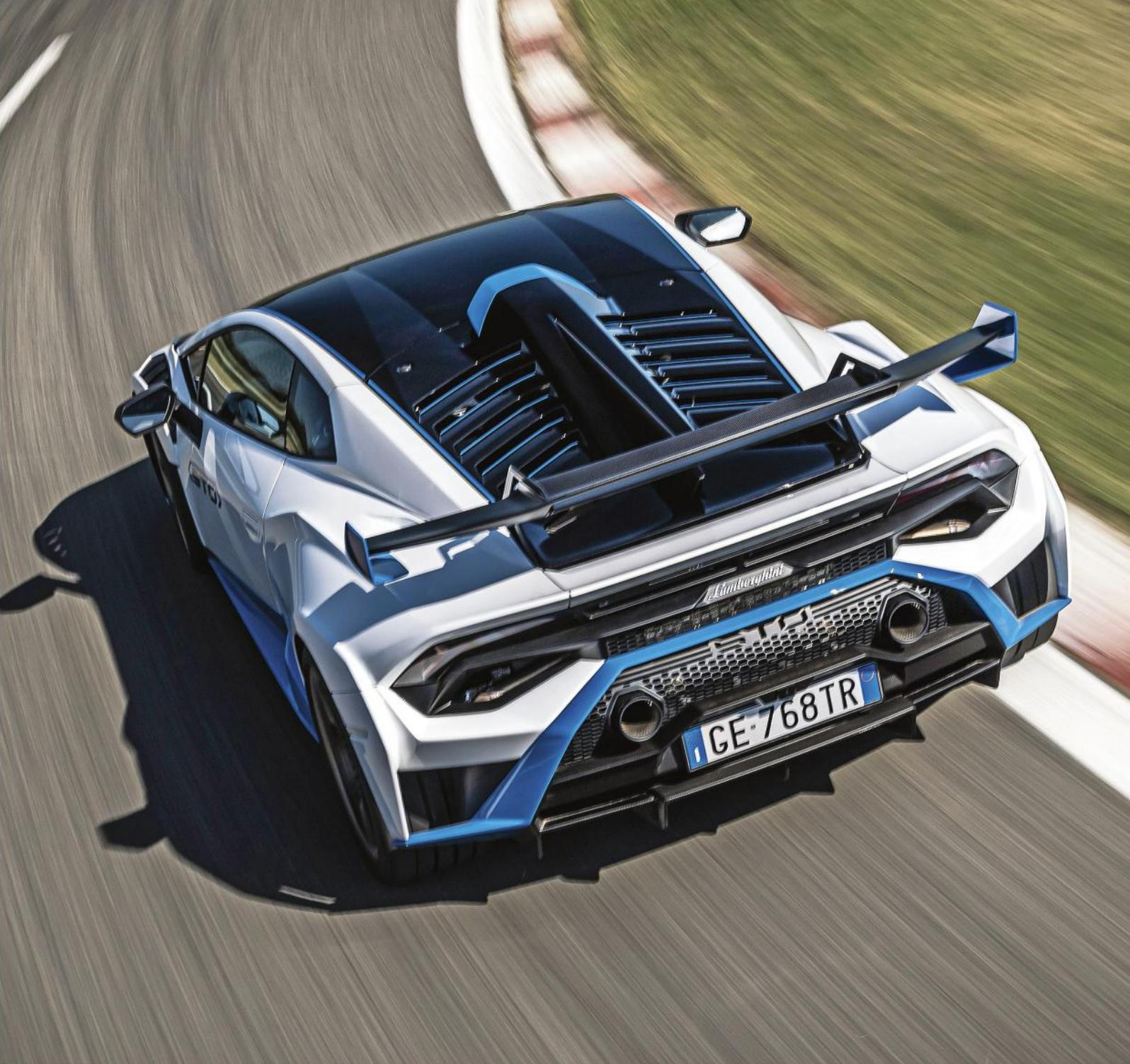
Se, infatti, poco cambia per il motore (il V10 5.2 aspirato da 640 CV, reso più aggressivo da scarico e mappatura specifici), a essere adattati sono altri elementi, come le tre modalità di dinamica di guida selezionabili e i freni, ora dei CCM-R della Brembo, più resistenti del 60% rispetto ai tradizionali carboceramici.
